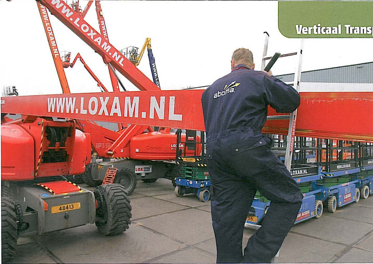
Wim den Toom van Aboma controleert de gehele staalconstructie van de hoogwerker en slaat hierbij geen centimeter over.
