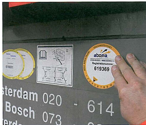
De sticker van Aboma is duidelijk: deze machine is goed door de technische inspectie gekomen en kan veilig worden ingezet.
